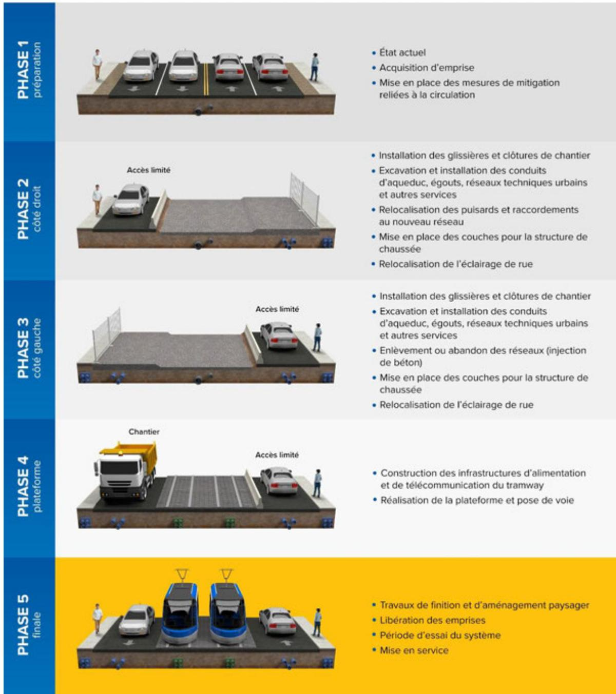
Figure 6.19 Exemple d'un phasage des travaux de construction du tramway
